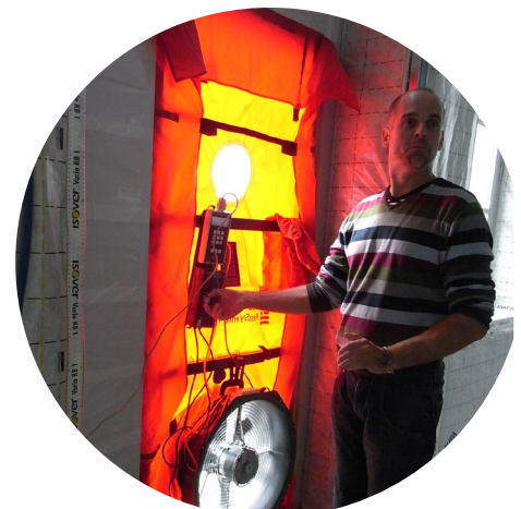
Test d'étanchéité à l'air
